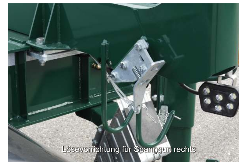
Insgesamt 2 Stück ExTe TU Luftman-Spanner
