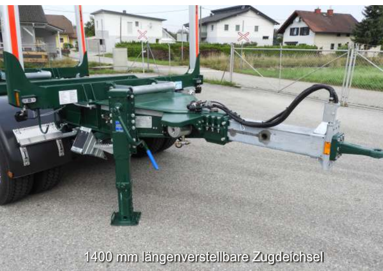
Versorgungsleitungen verlaufen geschützt im Zugrohr
