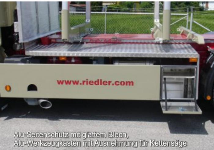
Alu-Seitenschutz mit glattem Blech, Alu-Werkzeugkasten mit Ausnehmung für Kettensäge
