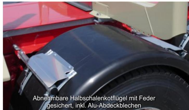
Abnehmbare Halbschalenkotflügel mit Feder gesichert, inkl. Alu-Abdeckblechen
