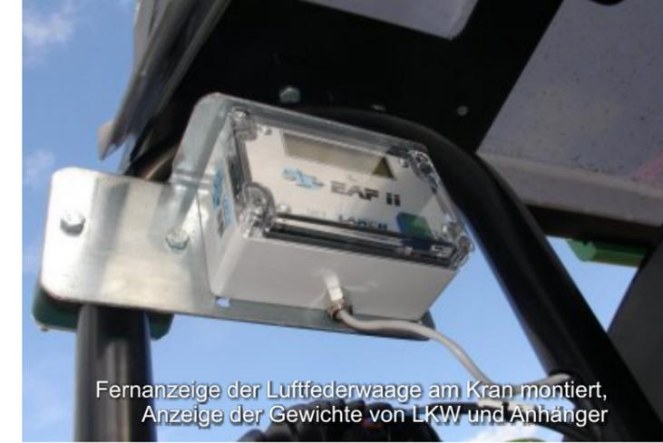
Fernanzeige der Luftfederwaage am Kran montiert, Anzeige der Gewichte von LKW und Anhänger
