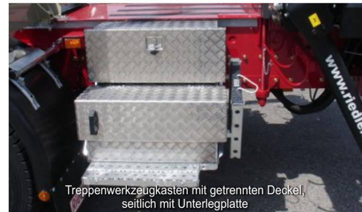
Treppenwerkzeugkasten mit getrennten Deckel, seitlich mit Unterlegplatte
