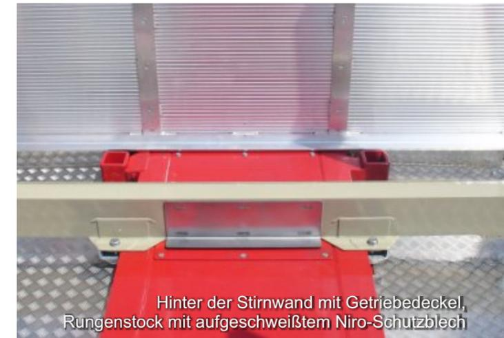
Hinter der Stirnwand mit Getriebedeckel, Rungenstock mit aufgeschweißtem Niro-Schutzblech
