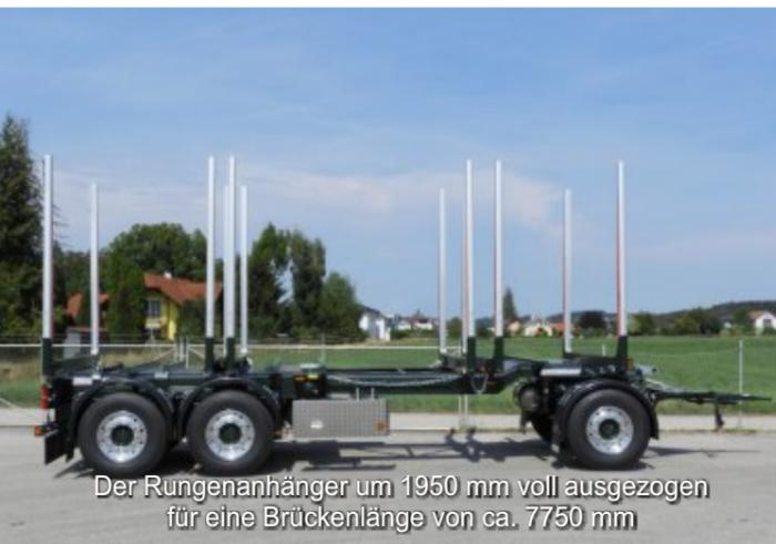
Der Rungenanhänger um 1950 mm voll ausgezogen für eine Brückenlänge von ca. 7750 mm
