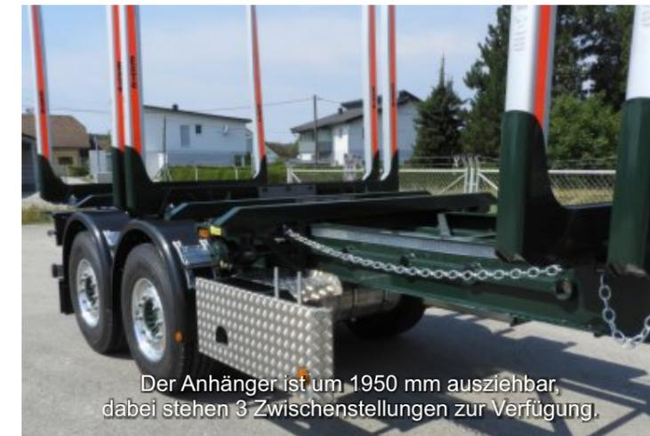
Der Anhänger ist um 1950 mm ausziehbar, dabei stehen 3 Zwischenstellungen zur Verfügung.
