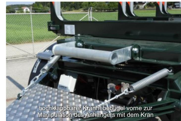
hochklappbarer Kranhebebügel vorne zur Manipulation des Anhängers mit dem Kran
