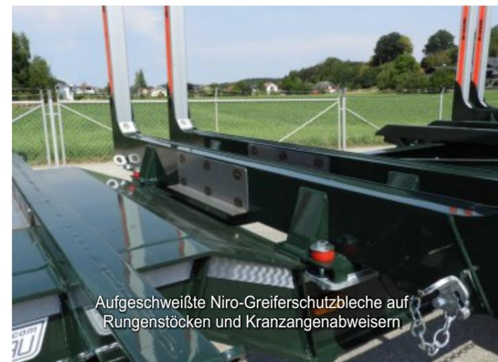
Aufgeschweißte Niro-Greiferschutzbleche auf Rungenstöcken und Kranzangenabweisern
